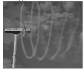
Visualisation de lâchés de fumée dans le sillage d'une éolienne. Jet de fumée sur une seule pale. (NREL, USA)
