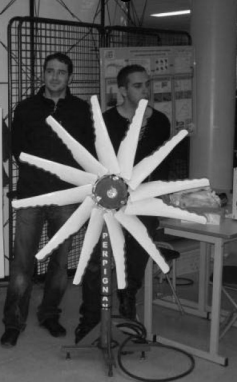
Eolienne de type "Américaine" Sous le vent à pales vrillées avec générateurs de Vortex
