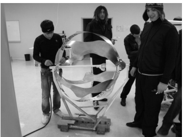
Eolienne Venturi à pales vrillées
