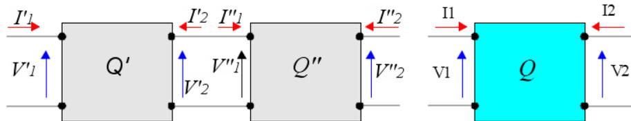
$$\begin{bmatrix} V'_1 \\ I'_1 \end{bmatrix} = [T'] \begin{bmatrix} V'_2 \\ -I'_2 \end{bmatrix} \quad \text{et} \quad \begin{bmatrix} V''_1 \\ I''_1 \end{bmatrix} = [T''] \begin{bmatrix} V''_2 \\ -I''_2 \end{bmatrix}$$
