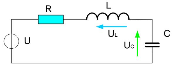
AN :  $R=100\Omega$  ;  $L=1\text{mH}$  ;  $C=1\mu\text{F}$  ;  $U_{\text{eff}}=100\text{V}$
