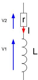
Une inductance réelle présente toujours une résistance (r due aux fils du bobinage) et une capacité parasite. Cette dernière est minimisée en bobinant les fils perpendiculairement (nids d'abeille). Ainsi, on représente une inductance réelle par une résistance de faible valeur en série avec une inductance pure. L'impédance équivalente vaut :  $Z_{\text{équi}} = r + jL\omega$
