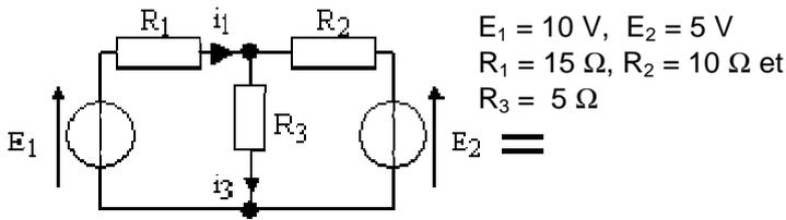
On veut exprimer  $i_3$ , en fonction de  $E_1$ ,  $E_2$ ,  $R_1$ ,  $R_2$ , et  $R_3$ .
