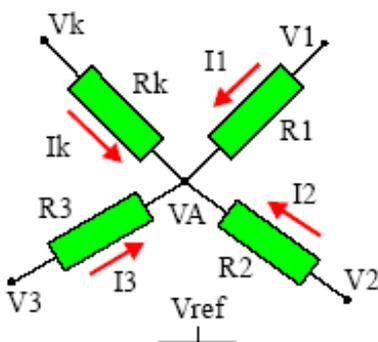
Au nœud A :  $I_1 + I_2 + \dots + I_k = 0$
