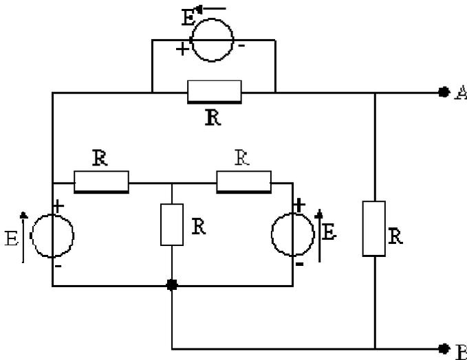
Pour le schéma ci-contre, déterminer par application du théorème de THEVENIN, le dipôle équivalent entre les bornes A et B.
