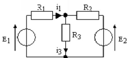
Calculer la tension aux bornes de R3 ainsi que le courant  $i_3$  qui la traverse.
