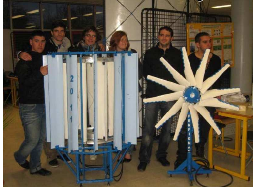
Eolienne de type "Turbine" à stator et rotor avec double génératrices
